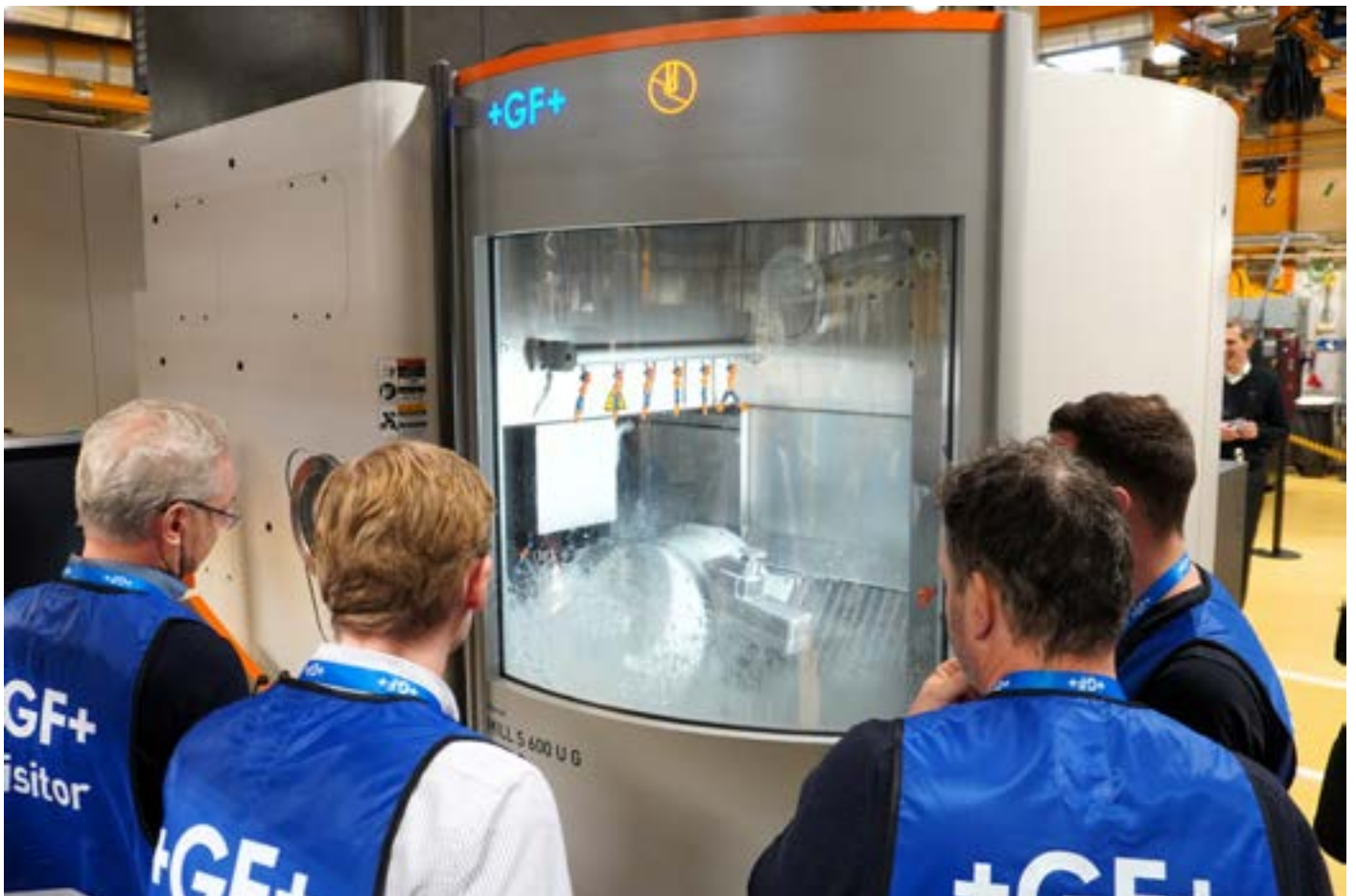
Een kijkje in de vijfassige Mikron Mill S 600 U G die System 3R inzet om nauwkeurige spansystemen te produceren.
