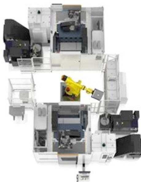
De schaalbaarheid van de machine MILL P 800 U S met automatisering is onbeperkt doordat meerdere machines van hetzelfde type aan de robotcel kunnen worden toegevoegd
