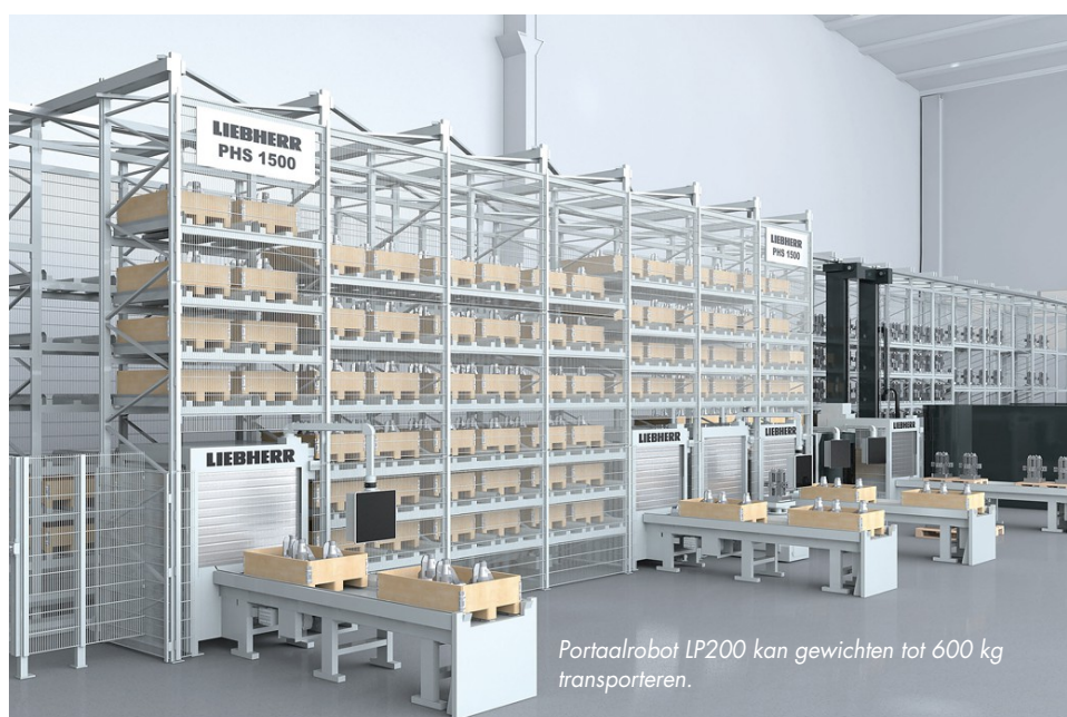
Het rotatielaadsysteem RLS met palletmagazijn kan aan een bewerkingsstation worden gekoppeld.
