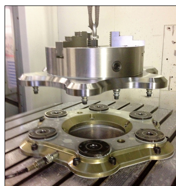
Onderzijde van een spanplaat voor een klauwplaat met vier nippels voor klemming in de chucks
