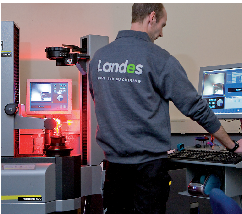
Het voorinstellen van het gereedschap gebeurt evenals het opspannen van de werkstukken buiten de machine.
