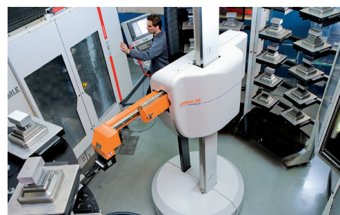
Centraal in de cel is een handlingrobot geplaatst.
