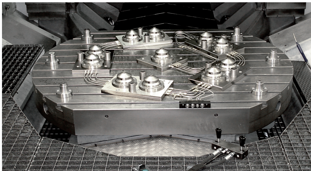
Afhankelijk van de grootte en het gewicht van het werkstuk wordt bepaald hoeveel opnamen op de machinetafel worden gemonteerd (foto is niet bij Landes genomen)
